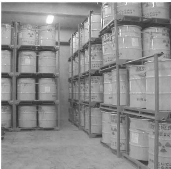
写真1 ウラン廃棄物の保管状況（例）
