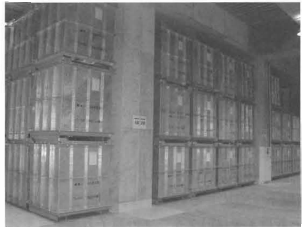
写真2 廃棄物入ボックスパレット保管状況
